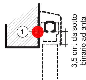
① Uscita cavi allineata alla parte inferiore del binario
