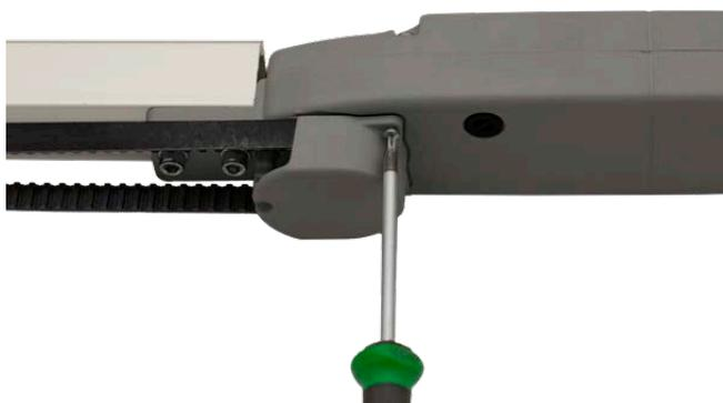
A completamento dell’installazione, è obbligatorio il posizionamento delle cuffie di protezione, anticaduta cinghia. La cuffia di protezione, posta sia lato motore che lato puleggia motrice, ha il compito di mantenere la cinghia allineata alla puleggia e al tempo stesso funge da sistema anticaduta della cinghia. La cuffia di protezione si fissa in 3 punti. Per la puleggia motrice vengono date in dotazione 2 viti autofilettanti 2,9x9,5 e 1 vite autofilettante 2,9x22, testa phillips PH1.
