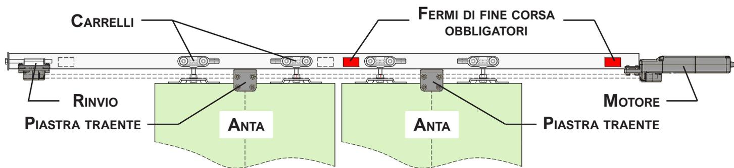
Nella figura è rappresentato in modo schematicizzato un sistema motorizzato scorrevole a due ante. E' importante notare la presenza degli stop a fine corsa in apertura e in chiusura. Essendo entrambe le ante collegate al medesimo sistema e alla medesima cinghia, è obbligatorio il posizionamento di almeno un fermo di fine corsa in apertura e in chiusura su di un'anta.
