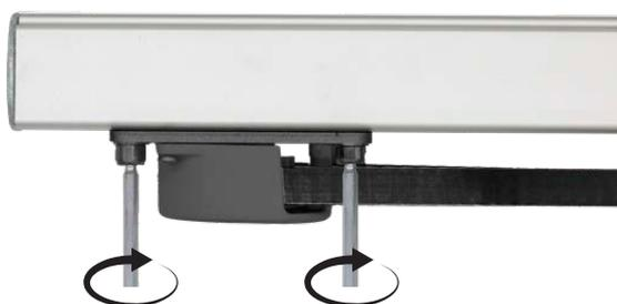
Una volta tensionato il sistema, bloccare la puleggia di rinvio al binario in modo il gruppo mantenga il tensionamento inalterato nel tempo, stringendo in modo deciso le 2 viti poste inferiormente al gruppo (2x viti EN ISO 4762 M5x16)
