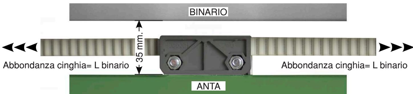
Premondate la piastra traente p.t.1 (rivolta verso muro) all'anta smontata, ancor prima di agganciare l'anta al binario. Fissate la piastra traente alla cinghia in modo "passante", avendo cura di avere cinghia in abbondanza per ogni lato, almeno pari alla lunghezza del binario (per ogni lato).
