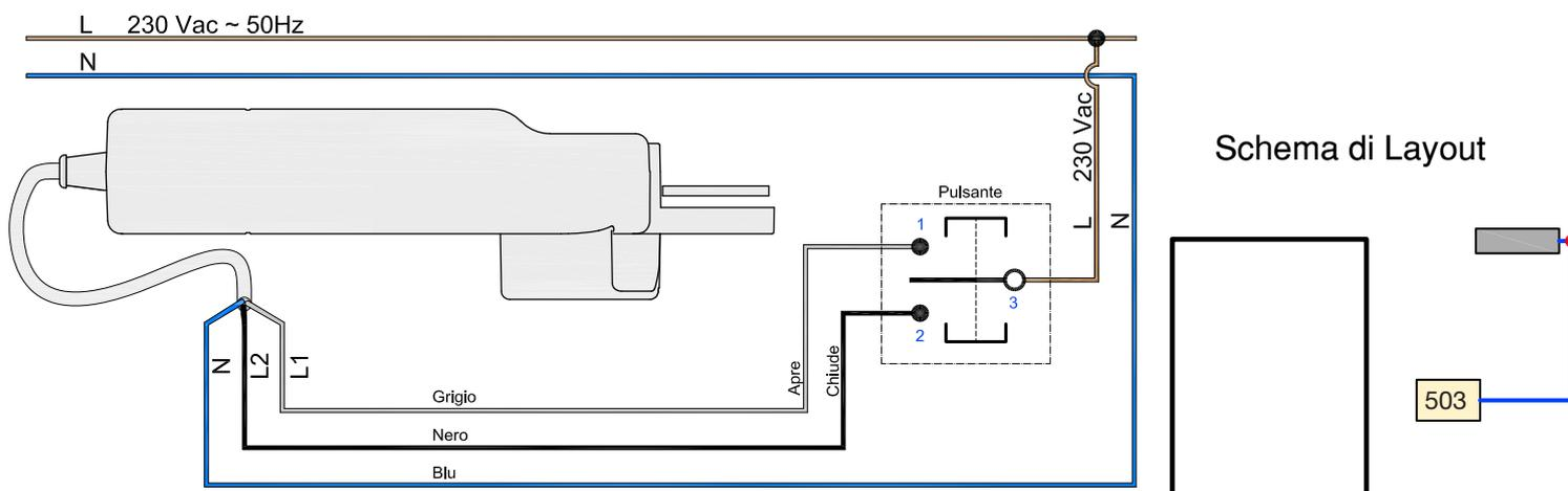
Cavo motore a 5 poli diam. 8mm. (Vengono utilizzati 3 cavi come da schema elettrico)
