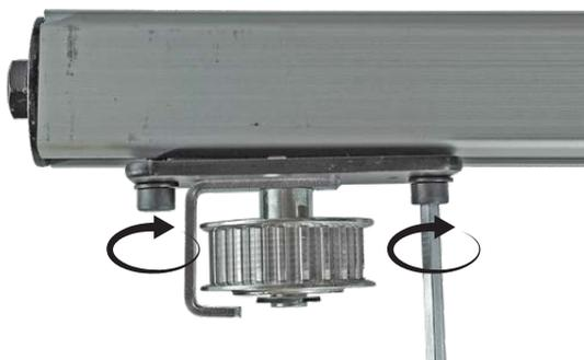
Una volta tensionato il sistema, bloccare la puleggia di rinvio al binario in modo il gruppo mantenga il tensionamento inalterato nel tempo, stringendo in modo deciso le 2 viti poste inferiormente al gruppo (2x viti EN ISO 4762 M5x16)
