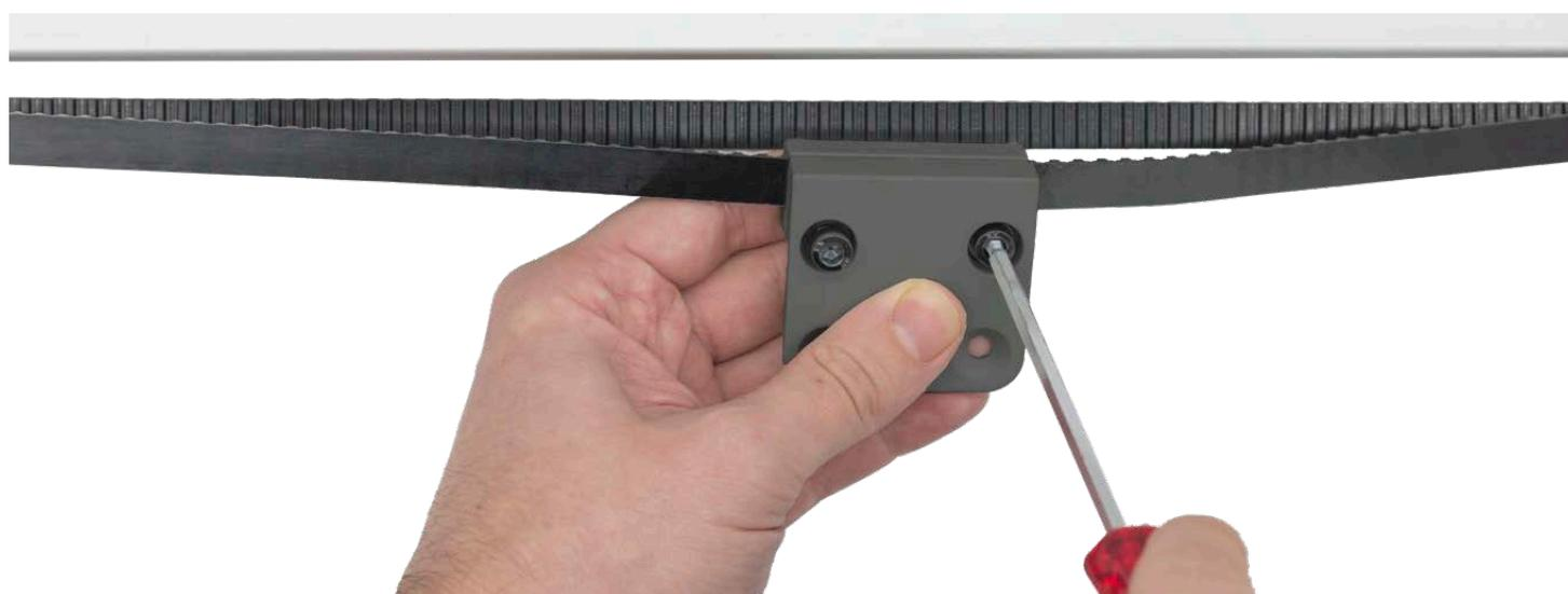
Posizionare i due lembi della cinghia sul morsetto di serraggio, facendo in modo che i due lembi della cinghia, provenienti dalla puleggia motrice da un lato e dalla puleggia di rinvio dall'altro, si uniscano. L'impronta in negativo presente sul morsetto di serraggio agevolerà l'operazione di posizionamento. Fissare tramite le due viti ad impronta esagonale la piastra traente al morsetto di fissaggio, completando il giro cinghia.
