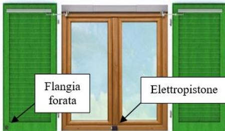
L'elettropistone è un accessorio **opzionale** e va montato in prossimità del fermo dell'anta principale in chiusura. Sull'anta, invece, andrà montata una piccola flangia forata che, quando sarà in posizione di chiusura, tale foro, dovrà collimare con l'elettropistone.
