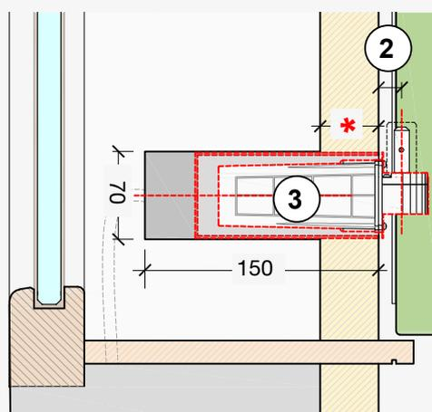
\* Attenzione: l'installazione su cappotto deve prevedere l'integrazione di un adeguato supporto alla calotta di fondazione.
