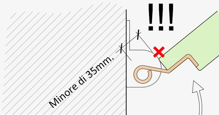
contatto dell'anta al corpo motore e blocco dell'anta che non può compiere completa apertura
