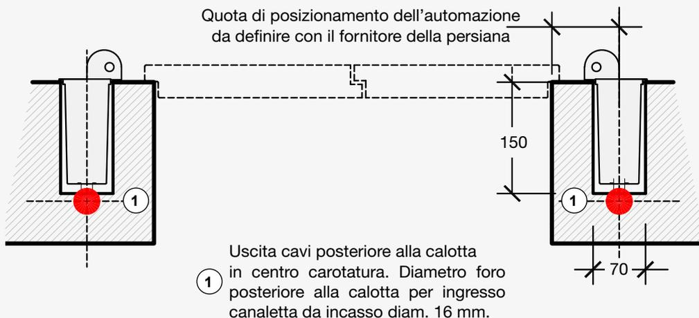
Uscita cavi posteriore alla calotta in centro carotatura. Diametro foro posteriore alla calotta per ingresso canaletta da incasso diam. 16 mm.
