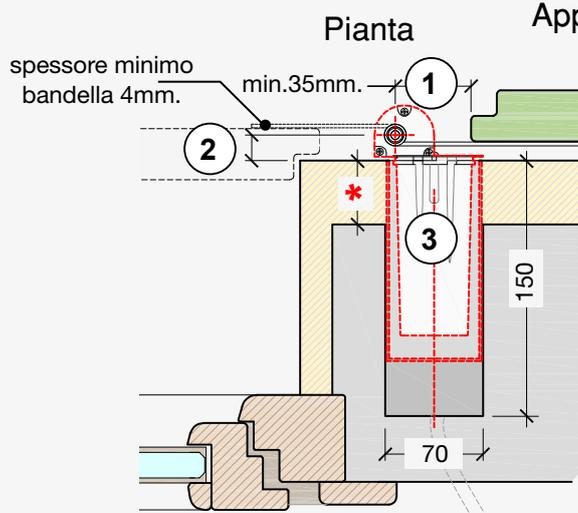
\* Attenzione: l'installazione su cappotto deve prevedere l'integrazione di un adeguato supporto alla calotta di fondazione.
